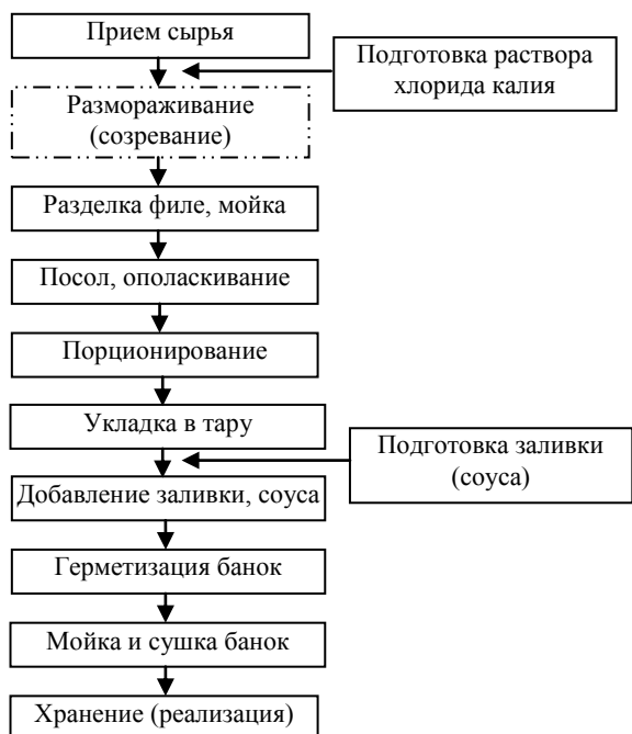
Рис. 1. Технологическая схема производства пресервов с использованием нового способа созревания
