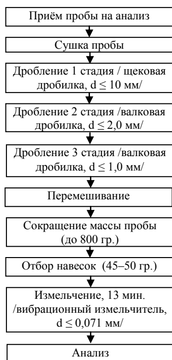
Рис. 1. Усовершенствованная технологическая схема подготовки лабораторных проб горных пород, руд и минералов к анализу
